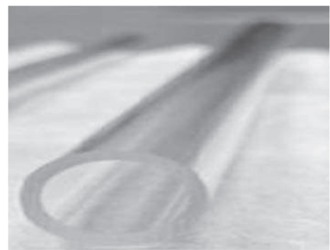
図2 透明アクリルパイプ (長さ 28 cm, 内径 10 mm)
